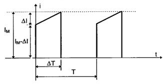
Osservando il grafico della forma d'onda si può pensare di calcolarne il valor medio come somma di due componenti, quella rettangolare e quella triangolare.
