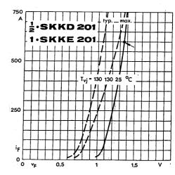
E' interessante notare come R<sub>F</sub> diminuisce al crescere della temperatura; contrariamente a quanto succede per i conduttori. Questo fenomeno è spiegabile con l'aumento di elettroni che passano dalla banda di valenza a quella di conduzione con l'aumento di energia termica.
